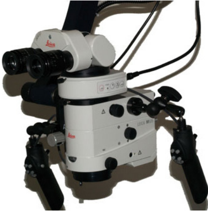
Microscopio motorizado Con los botones de la empuñadura podemos controlar el enfoque y la magnificación.
