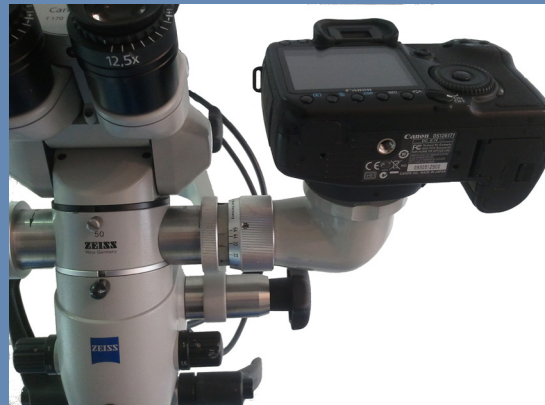
Sistema completo de documentación con beam splitter, codo adaptador y cámara SLR.
