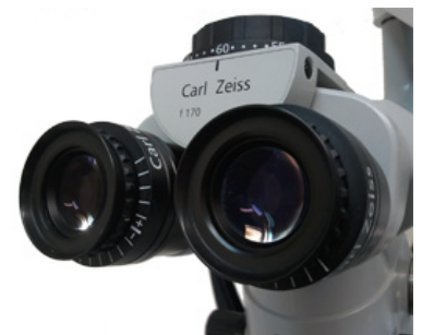
Oculares - obsérvese la posibilidad de adaptación de las dioptrías
